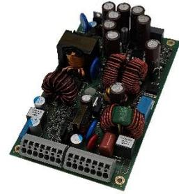
**Der topaktuelle HFBC250-2DW mit 250 W Power bietet einen ultraweiten Eingangsbereich von 14,4 V bis 154 V und ist bestens geeignet für leistungshungrige Anwendungen.**
